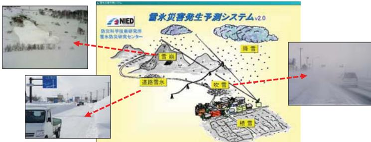
雪氷災害発生予測システムは、災害発生に関わる雪氷現象を物理法則に従って記述するモデルで構成されています。これによって降雪量、気象状態（風向・風速・気温など）、雪崩の発生危険度、吹雪による視程低下、道路の雪氷状態を予測します。
