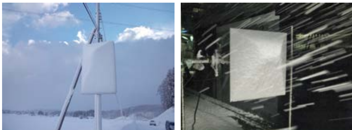
図1 道路標識への着雪（左図）と標準化（案）に従い風洞試験で再現された着雪（右図）
