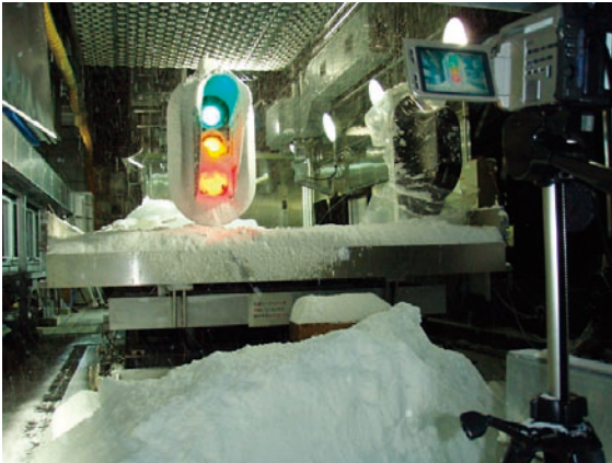
写真1 信号機の着雪実験
