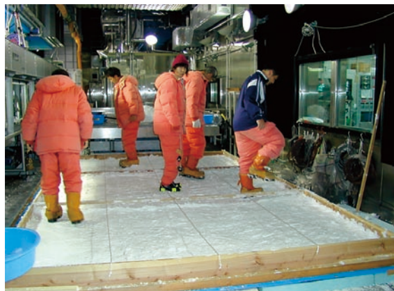
写真3 雪氷で覆われた歩道の滑り易さに関する実験
