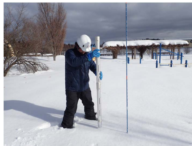
写真4-2 スノーサンプラー積雪採取
