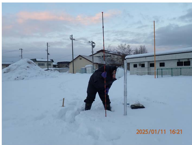
写真4-1 測深棒を用いた積雪深の測定
