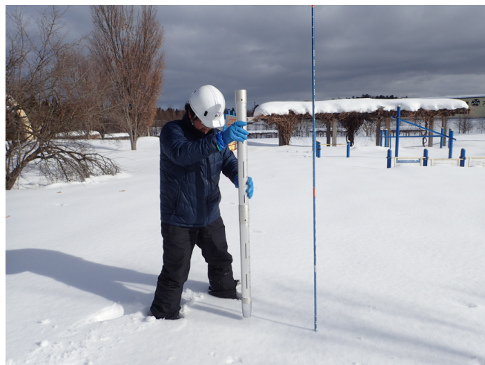
写真 2-1 スノーサンプラーによる積雪採取
