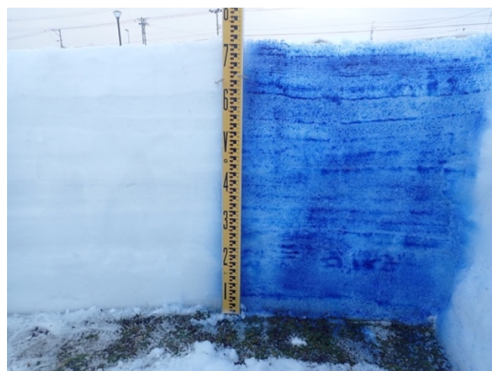
写真 2-2 積雪断面観測（弘前市 1 月の例）
