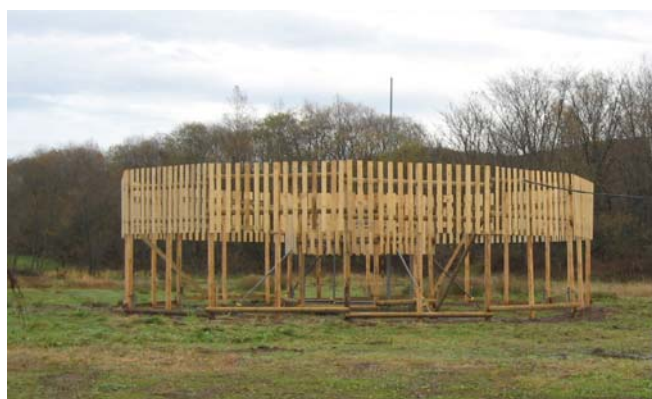
図7 北海道陸別町の下陸サイトに建設した DFIR 風除け柵。寸法及び構造は Rasmussen et al. (2012) と同じ。
