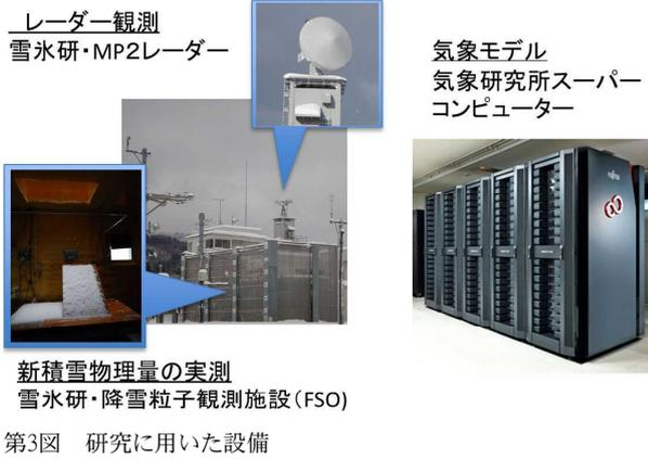
下、雪氷研)の降雪粒子観測施設(FSO; [Ishizaka, 2009](#))[\(第3図\)](#)においては降雪粒子を直接取り込む-3℃の低温室とSSAの測定装置を所有し、本研究ではこれらを用いて降雪を変質させずに $\rho_{init}$ とSSAを同時測定した。地上気象要素はFSOに隣接する気象観測露場において観測した。雪氷研では降雪頻度が高く(冬季は毎年、降水日数が比率にして約80%)、かつ様々な種類の降雪がもたらされるので、その利点を活かしたものである。
