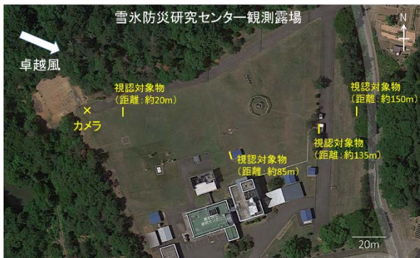
図3 雪氷防災研究センターの観測露場における視程計測イメージ
