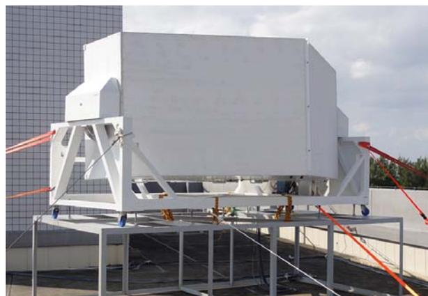
図 1 GPM 地上検証用 Ka 帯レーダ
