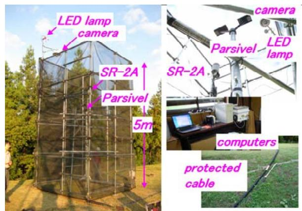
第2図 TESの露場に設置された十日町SPOS観測点。PARSIVELとSR-2Aは高さ5mの風除けやぐらの内部に設置され(図左)、それらはLED電球で照らされてWebカメラで着雪状況をモニターされる(図右上)。これらの機器は観測小屋設置のPC(図右中)と保護管に入れた長さ50mのケーブルで接続される(図右下)。
