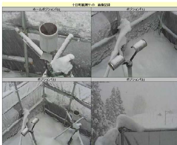
第3図 WebカメラによるSPOS着雪モニタリング画像の例
