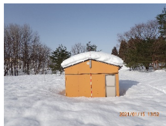
屋根雪の重量が実際に測れる試験棟
