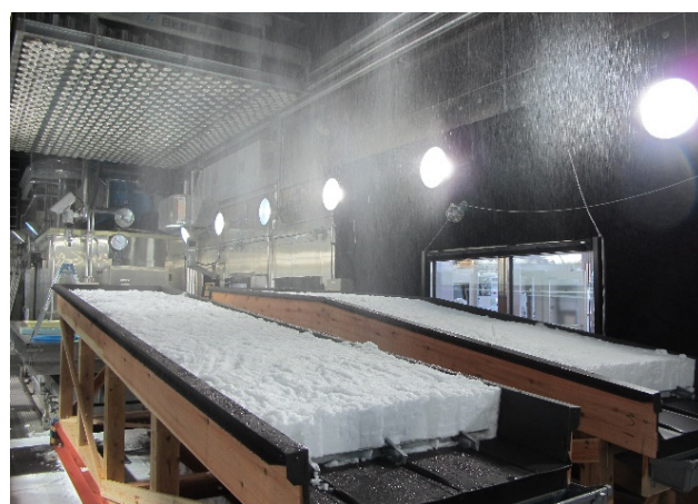
降雨装置を利用した屋根雪荷重試験
