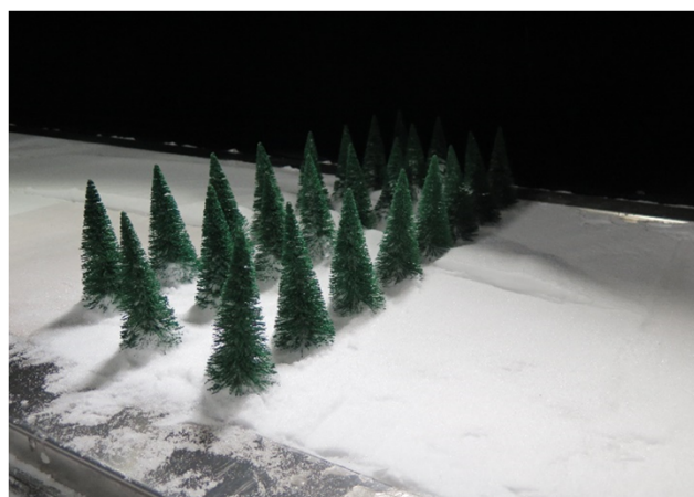
風洞試験による防雪林の吹き溜まりの効果検証
