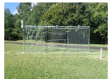
金網フェンスに掛かる積雪荷重を調べるための試験体
