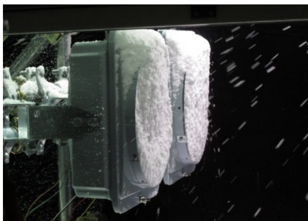
信号機の着雪再現試験
