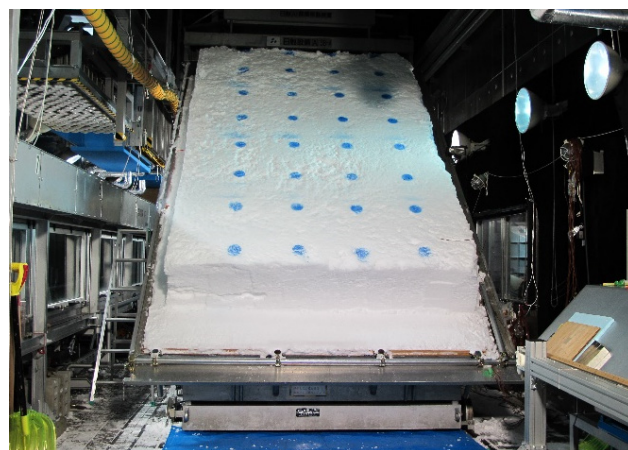
降雪テーブルを傾斜させた雪崩試験
