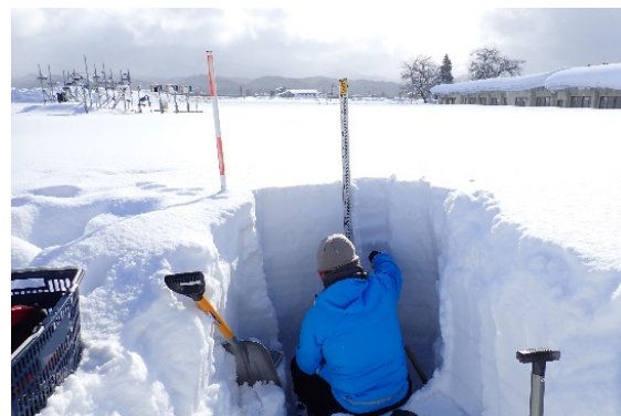
雪を掘って積雪の性質を調べる積雪断面観測
