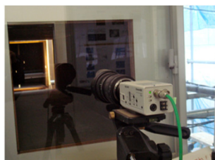
施設内に設置されたビデオ画像から降雪粒子の落下特性を計測する装置(左) この装置による典型的な雪片とあられの観測例(右)
