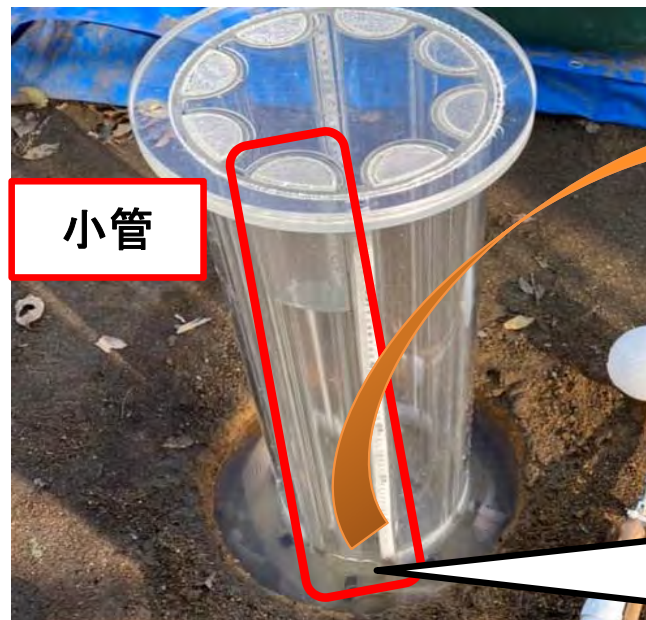
写真-6 使用した透水試験装置
