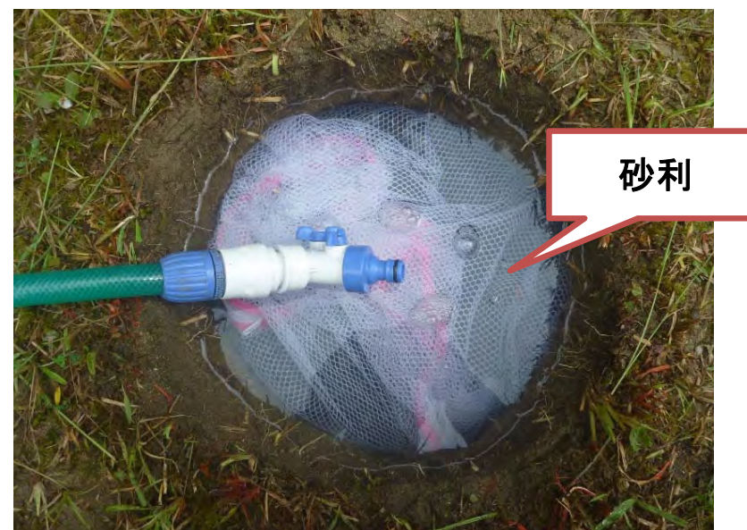
写真-3 予備注水中の試験孔
