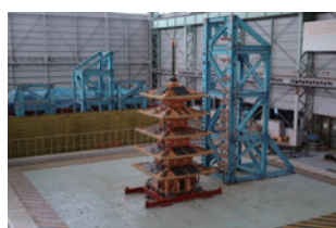
「五層建ての振動実験に関する研究」 (共同研究: 木の建築フォーラム、東京大学他)
