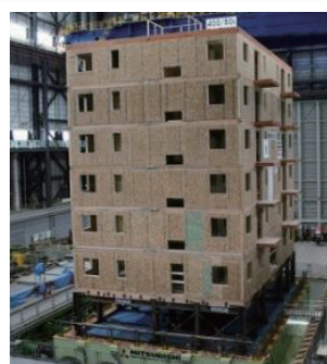
ウッドフレーム工法(日本名：ツーバイフォー工法)で建設された7階建て木造建物の大地震時の性能検証
