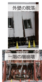
4層鉄骨造 完全崩壊実験 (2007年9月)
