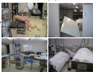
耐震構造での被害 (短周期地震動)
