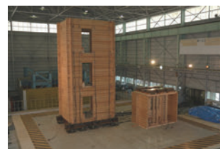
「丸太組構法の耐震性能及びせん断抵抗機構に関する研究」 (施設貸与: 財団法人建材試験センター)
