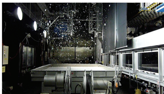
降雪状況(実験テーブルの大きさは3m×5m)
