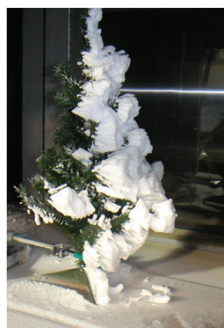
風洞装置による着氷実験(左)と蔵王の樹氷(右)
