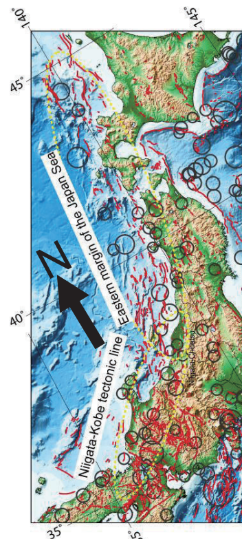
図1 ひずみ集中帯周辺で発生した大地震（黒丸、1586～2007年、深さ50km以浅）と活断層の分布（赤線）。黄破線で囲まれた領域は、北から日本海東縁ひずみ集中帯および新潟～神戸ひずみ集中帯。
