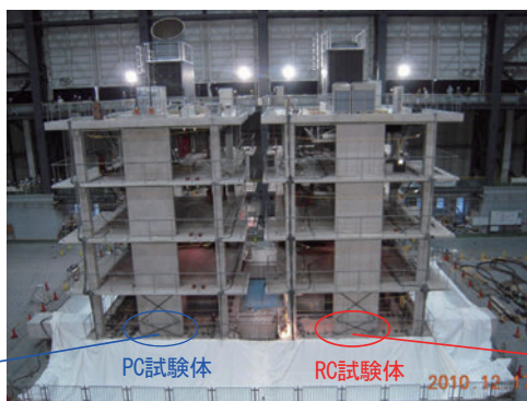
2010年12月 同時加振による震動実験 入力地震動 JMA神戸波 100% JR鷹取波 70%
