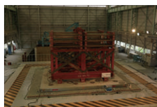
「エアー-断震システム空気浮上式装置実験」 (施設貸与: 免震住宅有価会社)
