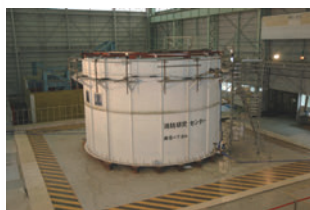
「石油タンクの内部浮き層様の振動実験実験」 (共同研究: 総務省消防庁消防研究センター)
