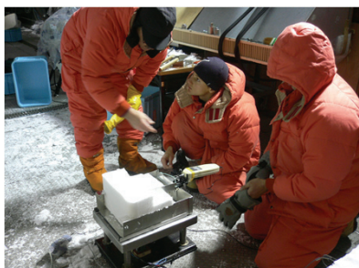
積雪の振動破壊実験 (ロシア雪崩安全センター)
