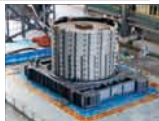
円筒形せん断土槽(内径8m、高さ6.5m)
