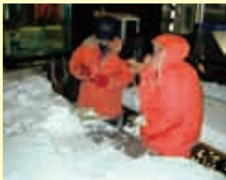
雪崩発生予測のための積雪剪断強度の測定
