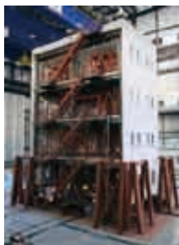
実大4層鉄骨試験体
