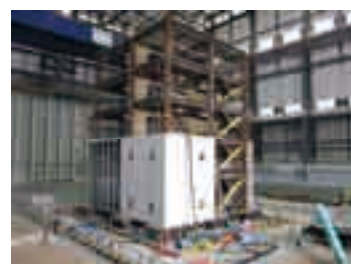
制振5層鉄骨試験体
