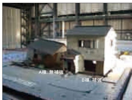
移築補強・無補強住宅実験(平成17年度)
