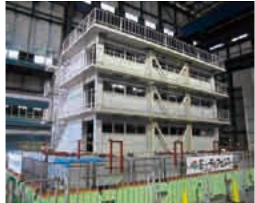
写真2 学校校舎の鉄筋コンクリート建物実験
