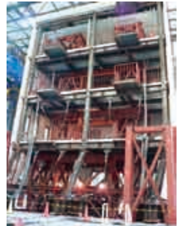
写真3 鉄骨建物実験
