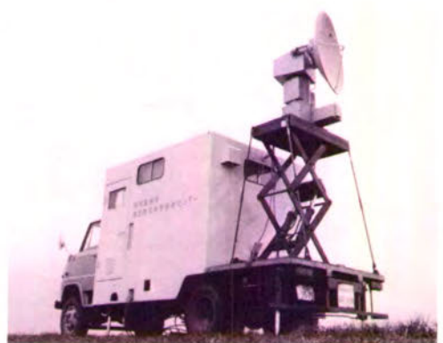
写真1 1969年に防災科研に初めて導入された車載式の気象レーダ。雷雨や降雹の観測に用いられた。現在は廃局となっている。
