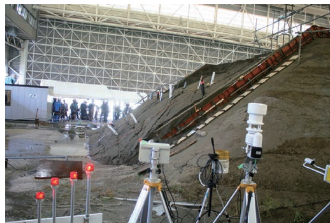
写真：崩壊後斜面とセンサー群
