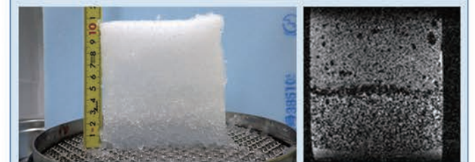
積雪中の水の浸透実験の写真(左)とそのMRI画像(右)
