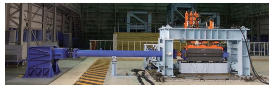
図1 大型二軸摩擦試験機の全体写真(幅約8m、高さ約2.5m)
