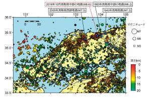
図1 2000年10月1日~2016年12月31日までの防災科研 Hi-net で決められた中国地方の震源分布(M≥1.5)
