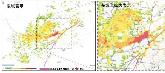
図1 J-RISQによる熊本地震本震の推定建物全壊棟数分布例 (左:広域表示、右:益城町周辺の拡大表示)
