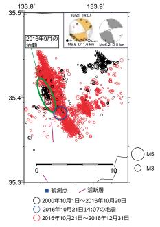
図3 高精度に再決定された2000年10月1日~2016年12 月31日までの2016年鳥取県中部の地震付近の震源分 布(M≥1.5)と発震機構解
