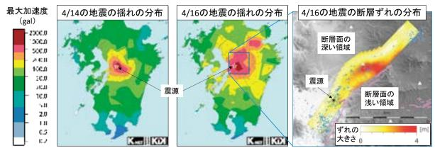
図1 K-NET、KiK-netが捉えた地震の揺れの分布と断層ずれの分布
