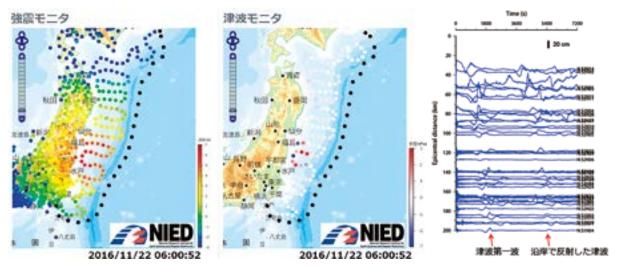
図1 福島県沖の地震の陸域(K-NET、KiK-net)と海域(S-net)の強震動データ(リアルタイム震度)を統合した揺れの伝播の様子(左:強震モニタ)と、S-netの水圧データによる津波の伝播の様子(中:津波モニタ)。動画は http://www.hinet.bosai. go.jp/topics/off-fukushima161122/をご覧ください。強震・津波モニタは、SIPの研究開発成果の一部です。右:S-netで観測された福島県沖の地震に伴う津波。
