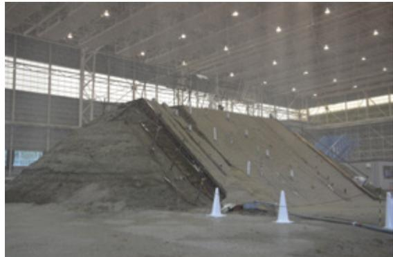
降雨実験中の斜面の様子
