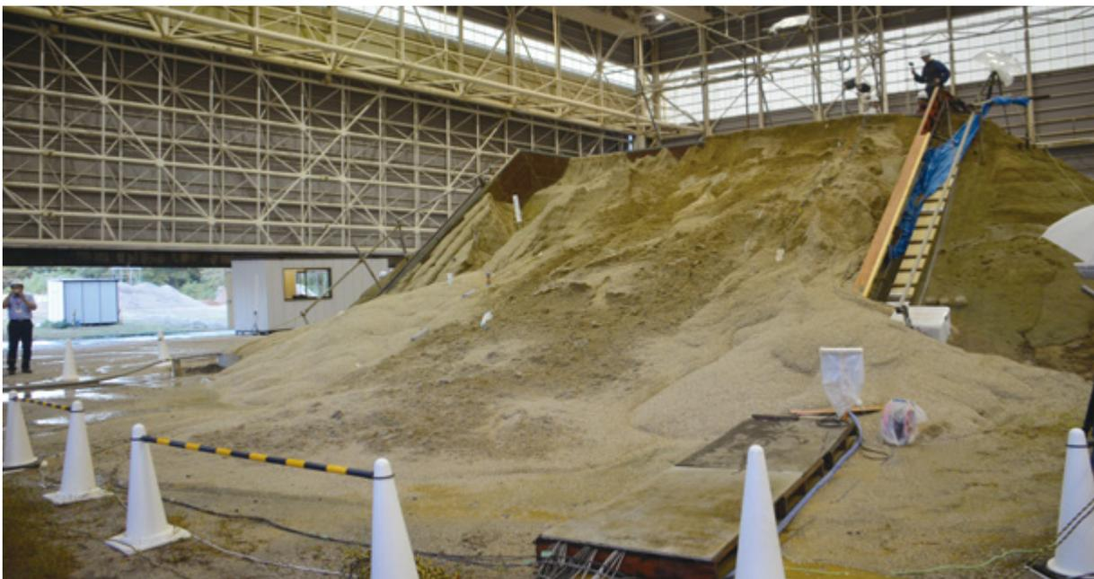
降雨による斜面崩壊後の様子
