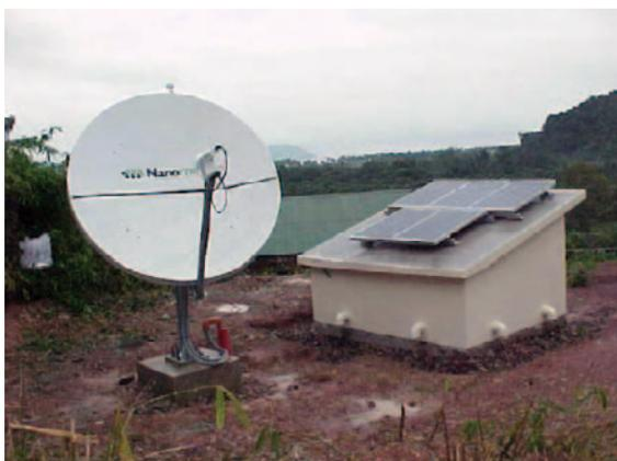
写真4 衛星テレメタ地震観測点
