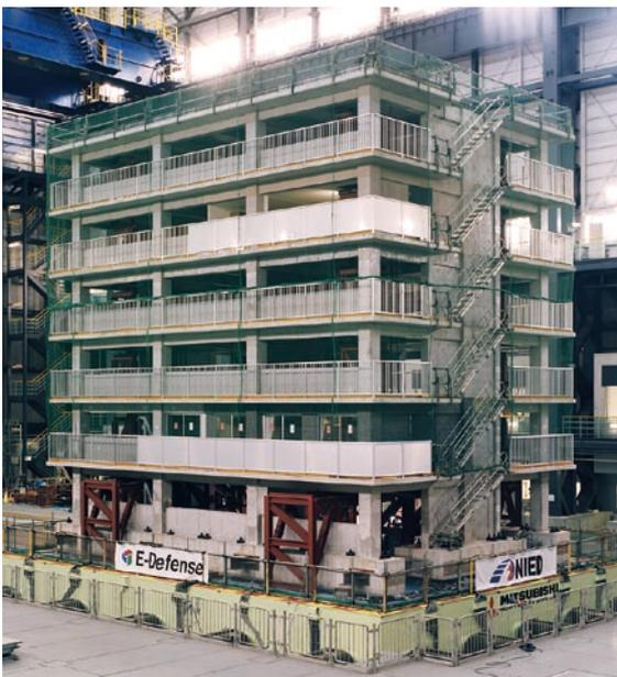
写真1 実大試験体 全景
