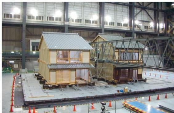
写真3 平成17年度の伝統構法木造建物試験体
