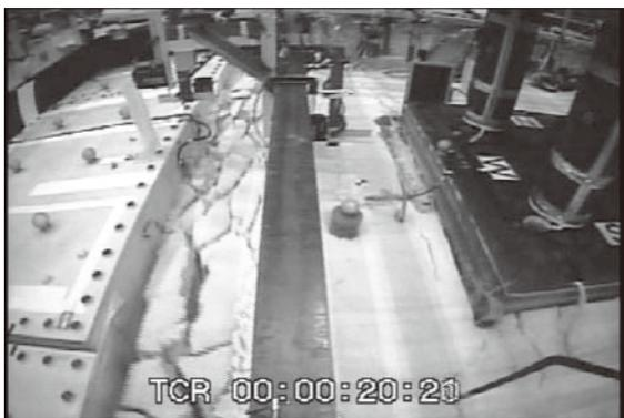
写真5 加振開始直後のケーソン背後地盤
