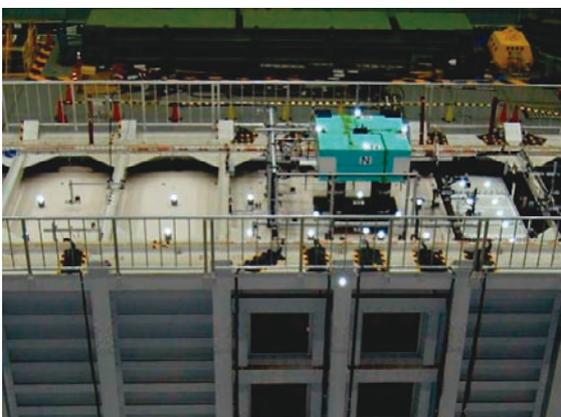
写真3 三次元変位計測の光反射マーカ
