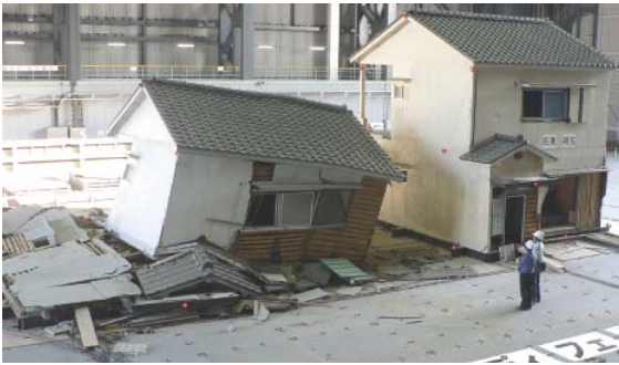
写真1 木造建物無補強・補強の比較実験
