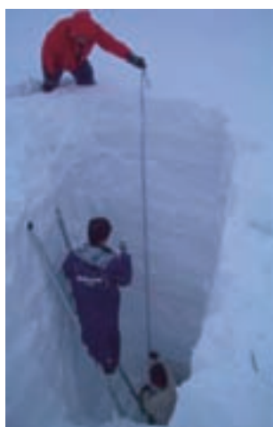
図1 豪雪に見舞われた新潟県津南町で3メートルもの雪穴を掘り、積雪内部構造や性質を調べています。
