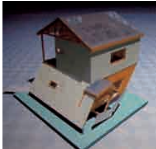
A棟（無補強）
