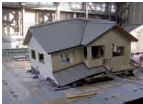
図4 J R 鷹取 3 回目の加振で倒壊
