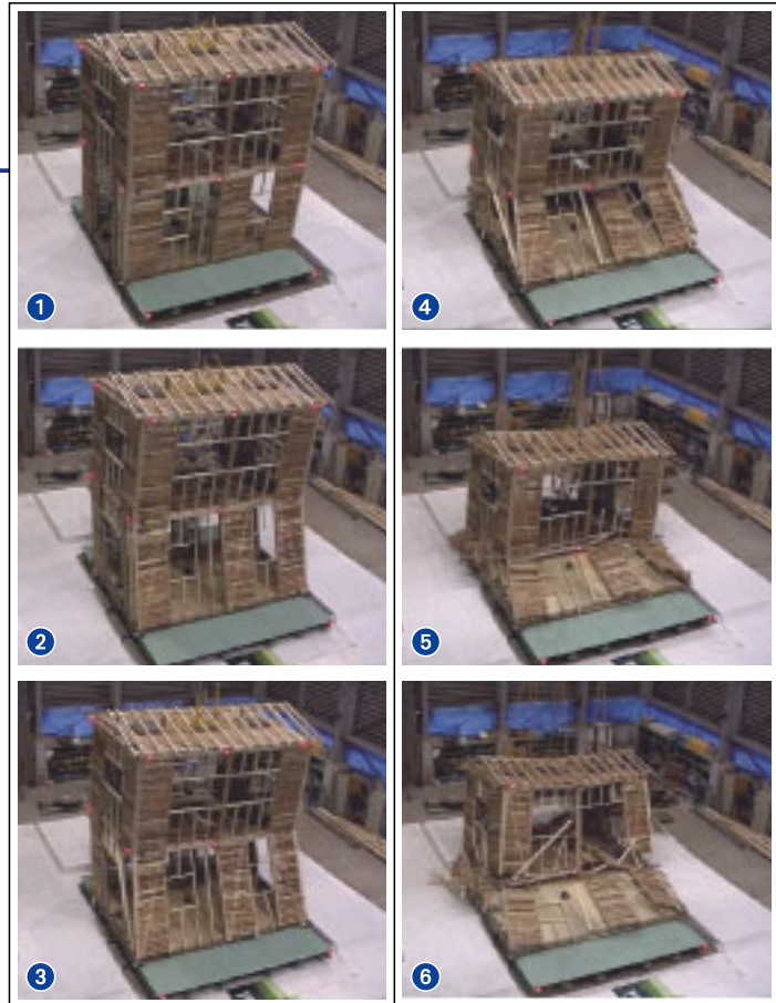
木造2階建て住宅倒壊の様相（2004.3.23実施）
