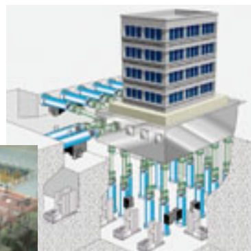
実大4階建て鉄筋ビルの実験イメージ
