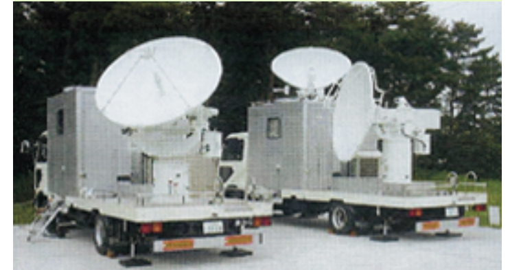
防災科研の新マルチパラメータレーダーシステム。右：降水観測用（波長3 cm）、左：雲観測用（波長8 mmと3 mmの2周波）。機動的な観測を行うために、普通免許で運転可能な4トントラックに搭載されています。降水観測用レーダーには衛星通信装置が備えられており、取得データの即時伝送が可能です。
