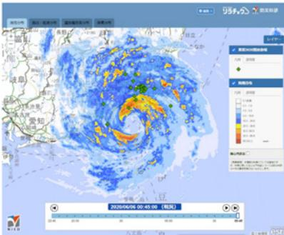
XバンドMPレーダーのデータを用いて開発した精度の高い降雨強度推定手法が実装されています。
