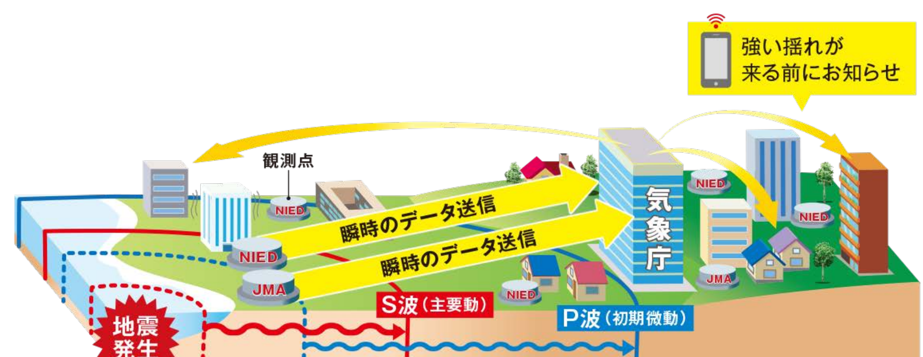
緊急地震速報の仕組み
