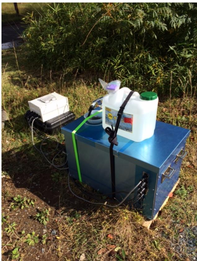
図2. 火山灰自動採取・可搬型分析装置 (VOLCAT: Visual Observation Laboratory Capturing Ash Transition)。火山灰を採取、洗浄、乾燥したあと分級し、その後、顕微鏡画像を撮影し任意のサーバーへ転送する。すべての工程を自動で行い、撮影インターバルなども調整可能。
