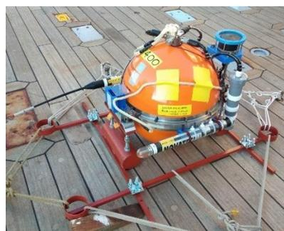
図 3 フィールド実証試験で用いられた、新型水圧計を搭載した自由落下自己浮上式海底圧力計
