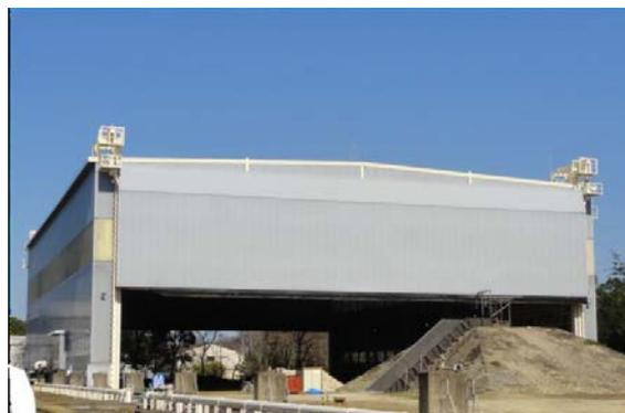
施設は、5つの実験区画と移動降雨装置、ポンプ制御棟、貯水槽から構成されています。昨年度改修工事を行い、現在は、散水面積44m×72m、降雨強度は1時間に15～300mm、雨滴粒径0.1～6mm、雨滴落下高16mという規模・能力となっております。
