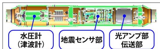
図2 観測装置の外観と内部模式図
