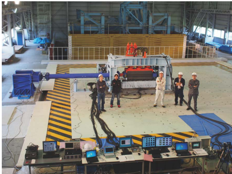
(a) 大型振動台上に設置された摩擦試験機の写真
