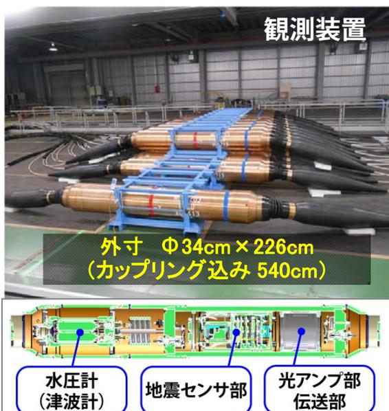
図2 観測装置の外観と内部模式図
