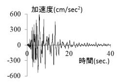
図2. 本実験で用いる JR 鷹取駅で観測された地震動
