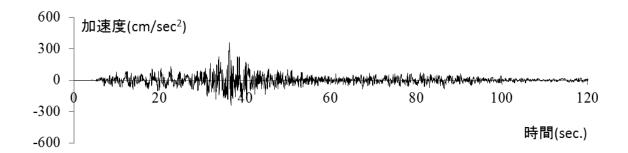
図3. 本実験で用いる南海トラフ巨大地震の想定地震動
