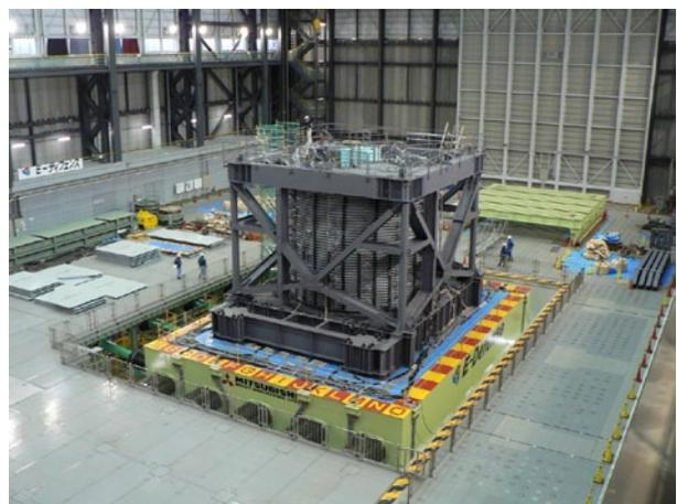
写真1：震動台上に設置された試験体
