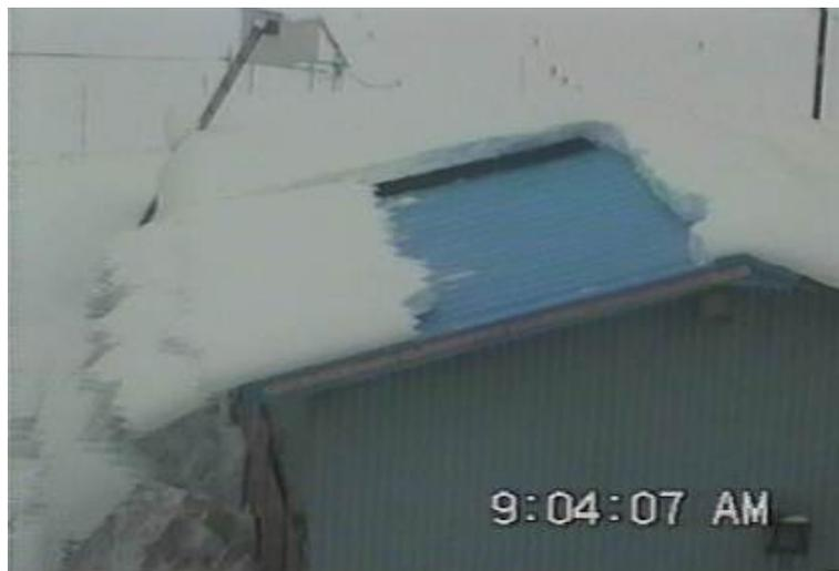
写真1 ブルーシートで覆われた実験屋根からの雪の自然滑落条件の観測
