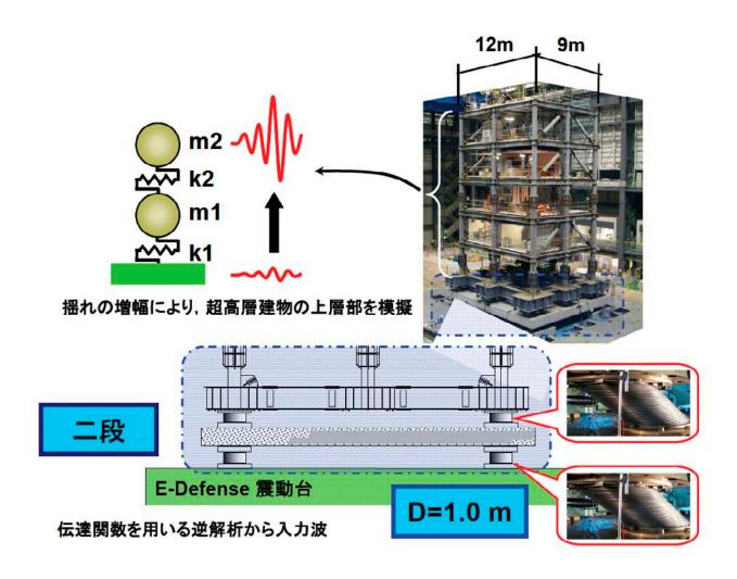
実験に用いる試験体
