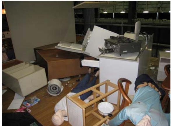
写真6 冷蔵庫等の転倒と移動
