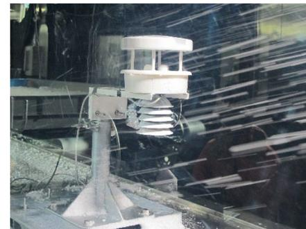
超音波風速計のヒータ対策検証
